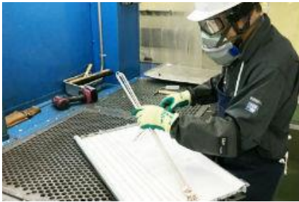
・蛍光灯取り外し作業
